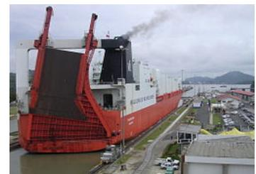
※**RO-RO船**：roll-on/roll-off shipの略称。フェリーのようにランプウェイを備え、トラックなどの車両を直接収納できる貨物船のこと
